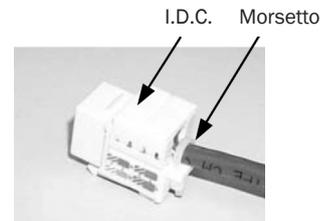
Inserire il cappuccio IDC per fissare tali cavi. Inserire il morsetto per stringere la guaina del cavo e completare l'installazione.
