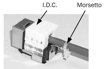
Inserire il morsetto per stringere la guaina del cavo. Inserire il cappuccio IDC per fissare tali cavi.
